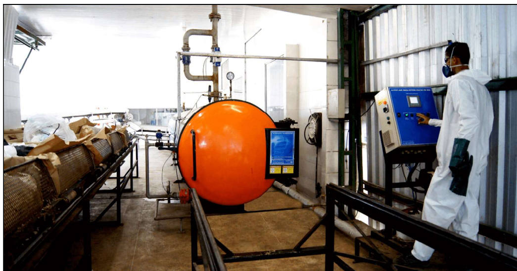
Figura 68 – Autoclave da Empresa Marca Ambiental em Cariacica Fonte: Empresa Marca Ambiental, 2019.
